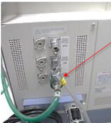
麻酔器背面のAIR接続ネジに酸素濃縮器ホースを接続
