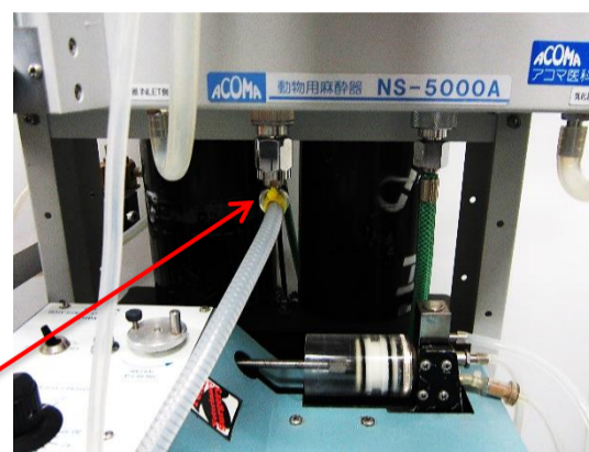
AIR 流量計を通して酸素濃縮器からの 酸素が運ばれます
